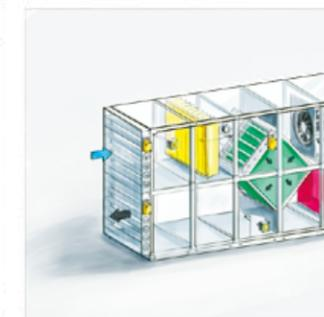
办公塔楼采用排风热回收系统, 进行能量回收, 降低空调制冷能耗。
